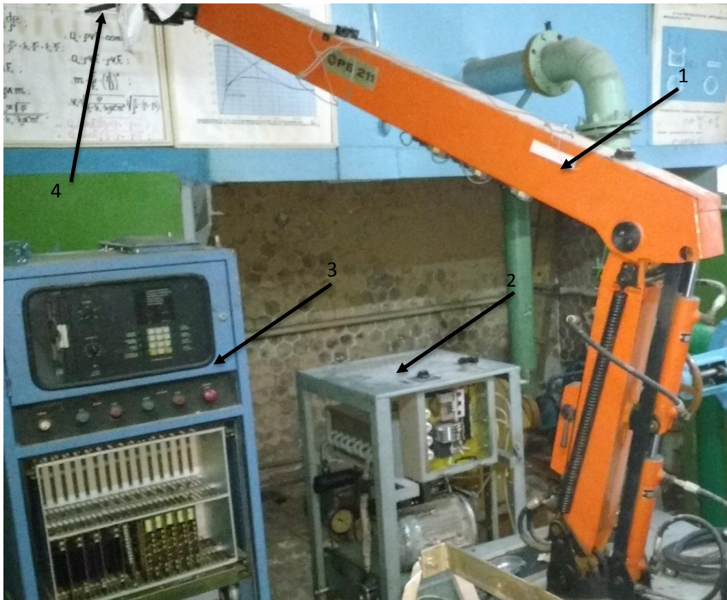
Рис.1. Загальний вигляд маніпулятора: 1-маніпулятор; 2-насосна станція; 3- пристрій управління; 4-фарбувальна головка
