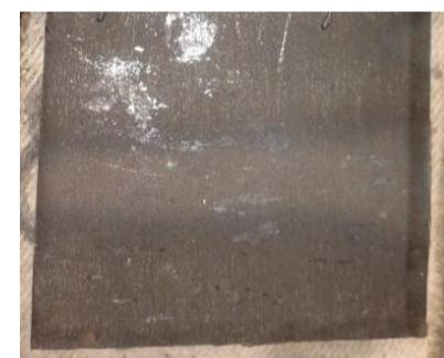
Рис.4. Зворотна сторона деформованого зразка після ЛГ
