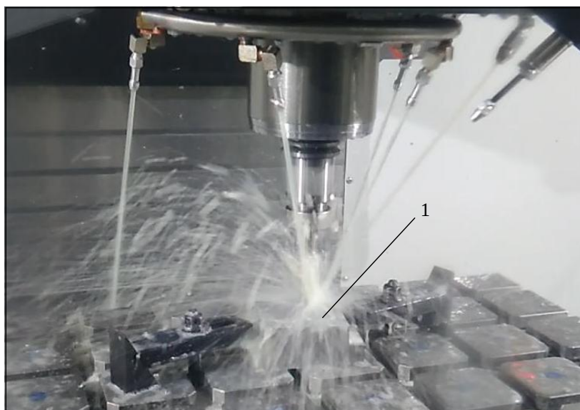
Рис. 3. Фрезерування контуру деталі
