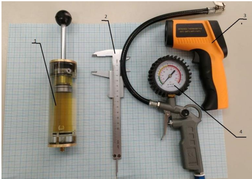
Рис.2. експериментальне обладнання: (1-демпер, 2-штальгель циркуль, 3-перометр, 4- пневмо пістолет)
