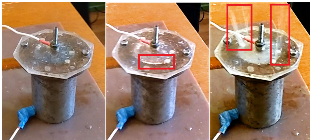
а) б) в) Рис. 4. Процес розряду у робочому іскровому розряднику: а) - початковий стан, б) - іскровий розряд, в) - витиснення рідини з стакану під дією високих тисків
