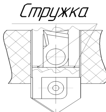
Рис. 3. Скупчення стружки під ножами
