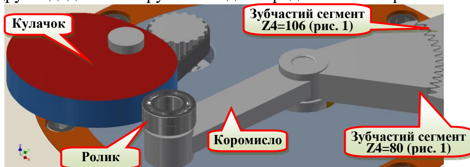
Рис.3. Компонування кулачкового механізму КМ2 (згідно кінематичної схеми) приводу другої додаткової кругової подачі
