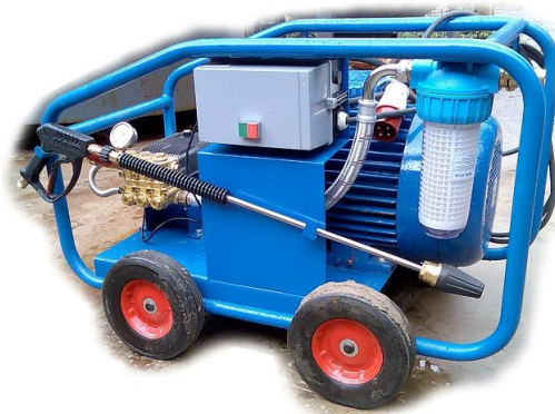
Рис. 1. Апарат гідроструменевої обробки «Шторм Power AR 500-25», з наступними технічними характеристиками:
