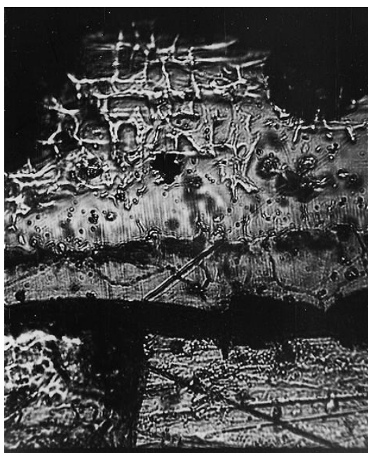
Рис. 2. Мікроструктура дифузійного шару на сталі 45 з попереднім Ni–Co–P покриттям за рецептурою №2. Режими: T=1050^{\circ}\text{C} , витримка \tau=7 год. (ізотермічна витримка \tau=1 год. при T=800^{\circ}\text{C} ). Збільшення 600^{\times}
