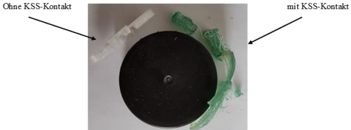
Abbildung 5. Strukturen aus T-Lyне mit/ ohne KSS-Kontakt
