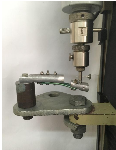
Рис. 3. Пластина 3М, розміщена на робочому столі випробувальної машин
