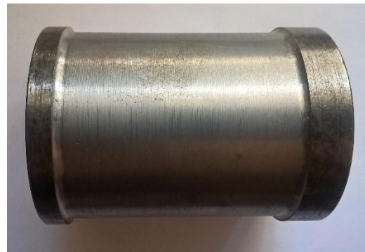
б) заготовка, яка отримана точінням з прокату
