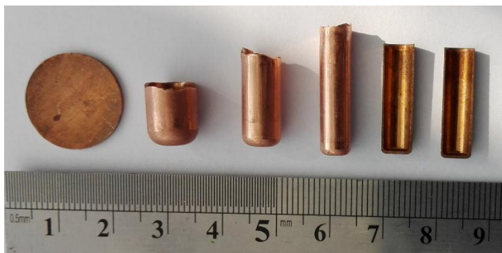
Рис. 6. Заготовка та напівфабрикати (поопераційно), після витягування (праворуч наведено деталь в розрізі).
