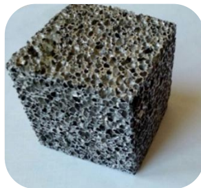
Рис. 6. Кубічний зразок з піно алюмінію
