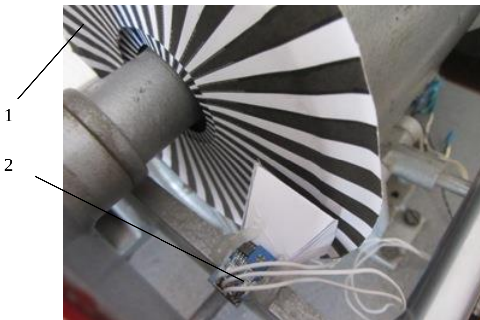
Рис. 2. Будова енкодера. 1- секторований диск, який жорстко встановлений на роторі, що балансується 2- оптопара.
