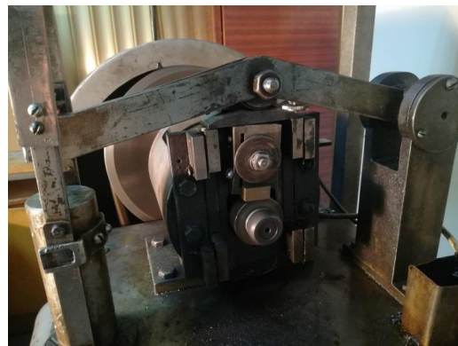
Рис. 1. Схема вузла тертя (а) та фотографія (б) машини М-22М: 1 - датчик вимірювання сумарного зношування пари тертя; 2 - механізм навантаження; 3- кожух голівки тертя; 4 - важіль навантаження; 5 - контрзразок (колодочка); 6 - датчик вимірювання сили тертя; 7 - пружина вимірювання сили тертя; 8 - кронштейн важеля навантаження; 9 - датчик вимірювання зношування зразка (ролика); 10 - зразок-вал (ролик).
